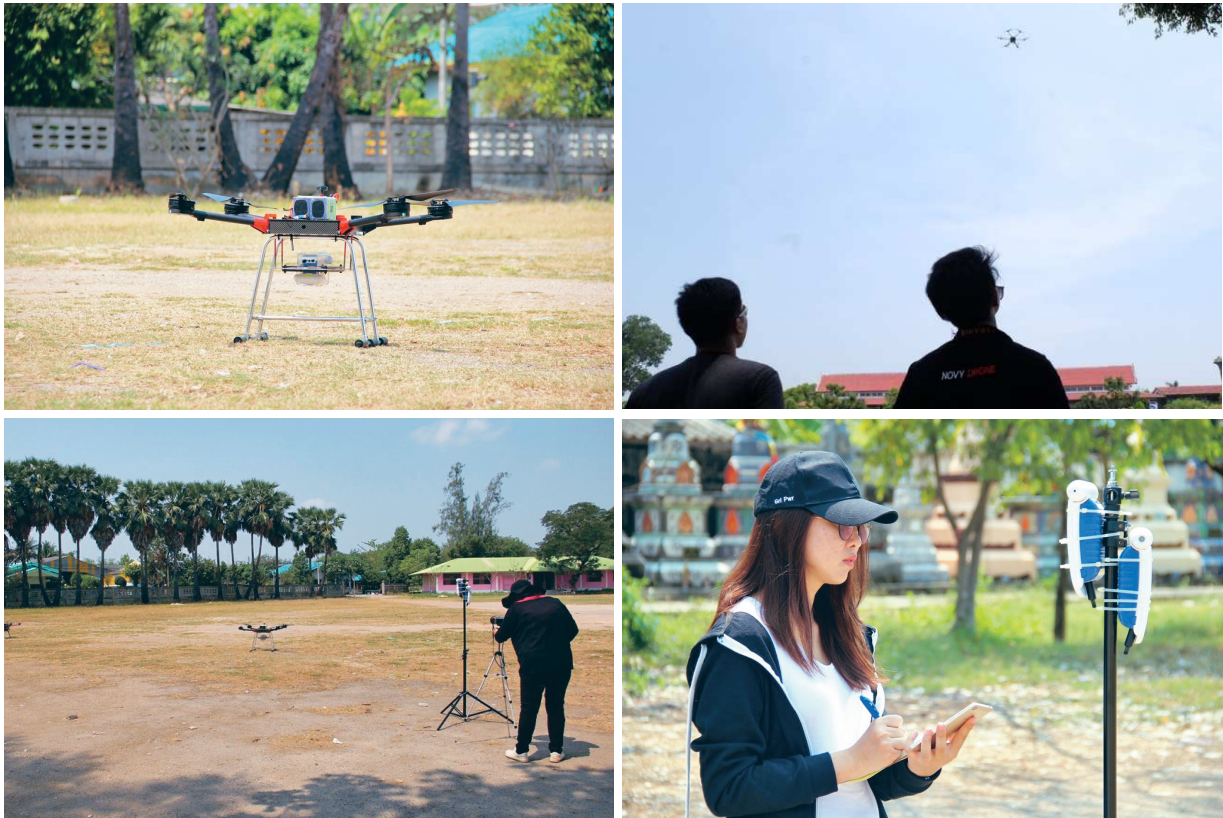
ภาพที่ 2 การติดตั้งเครื่องมืออากาศยานไร้คนขับ และตรวจวัดมลสารในอากาศบริเวณใกล้ผิวดิน
