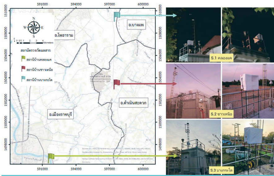
ภาพแสดงสถานีเก็บตัวอย่างฝุ่นขนาดไม่เกิน 2.5 ไมครอน (PM 2.5 ) บริเวณโดยรอบโรงไฟฟ้าราชบุรี
